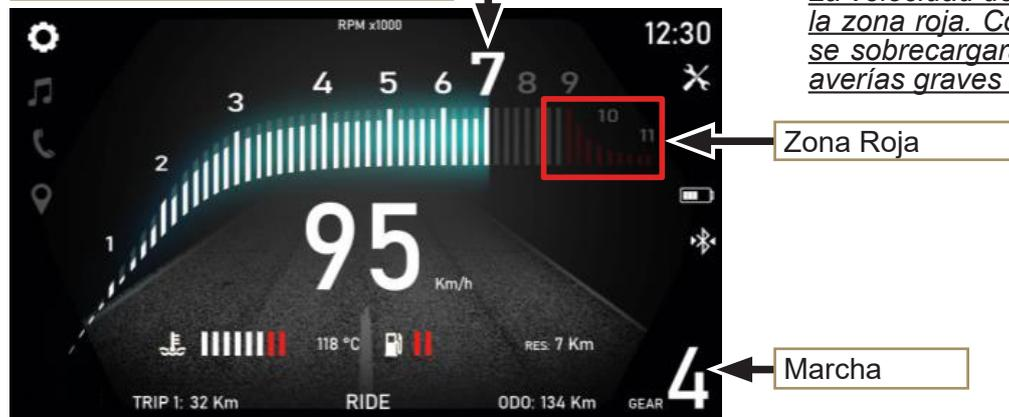
**Indicador de combustible:** La cantidad de combustible se indica en ocho segmentos. Cuando la cantidad de combustible ocupa un segmento, la pantalla se volverá roja y la alarma combustible se encenderá. Cuando el indicador de combustible no muestra segmentos, significa que el combustible restante disponible es de aprox. 2 litros. Se aconseja cargar combustible lo antes posible.
